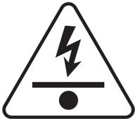
**Vorsicht, flach verlegtes Kabel** – warnt den Anwender, wenn das zu ortende Kabel sehr flach unter der Oberfläche verlegt wurde
