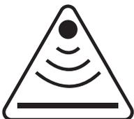
**Vorhandenes Freileitungssignal** – warnt den Anwender vor vorhandenen Signalfeldern durch Freileitungen / Hochspannungstrassen
